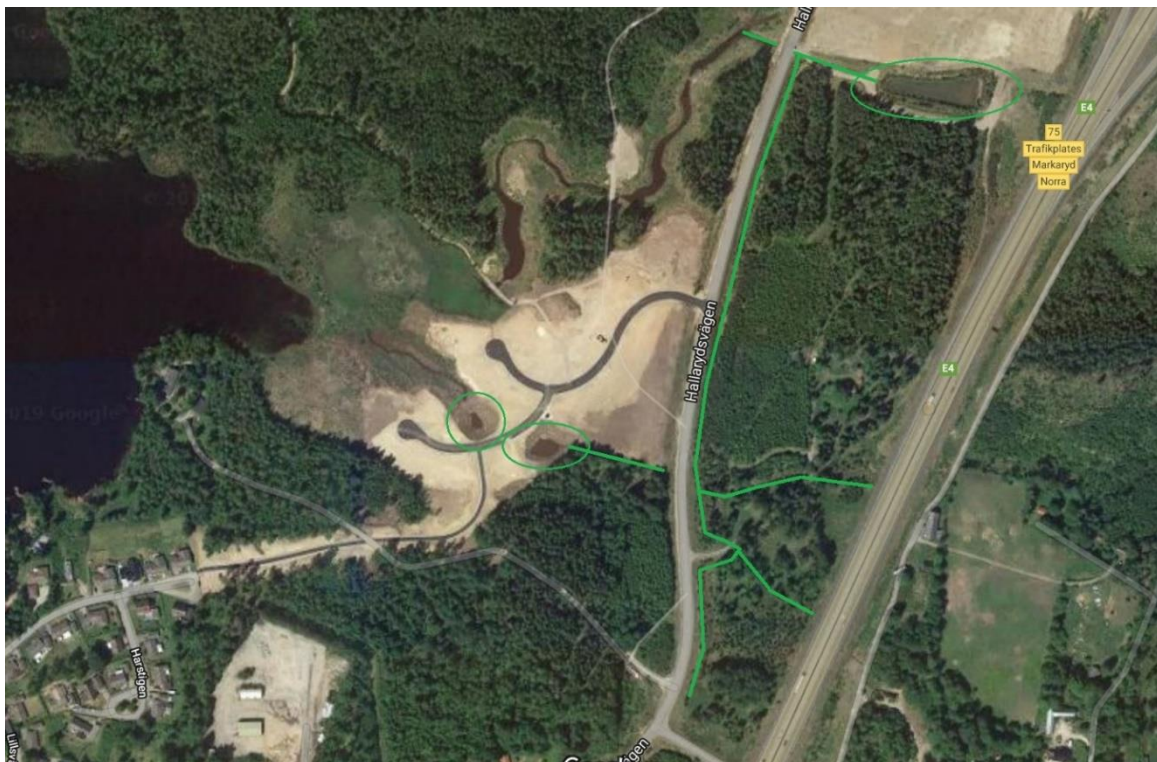
Figur 7. Satellitbild från google maps som visar dagvattendammar (inringade) vid Diamantvägen samt Trafikverkets sedimentationsdamm (inringad) i norr.
