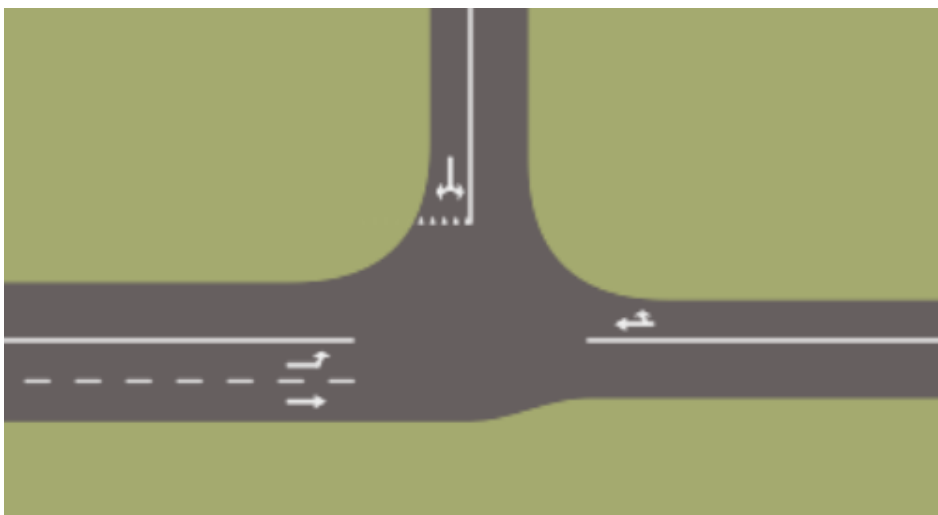
Figur 8. Korsningsutformning - vänstersvängfält på väg 15.
