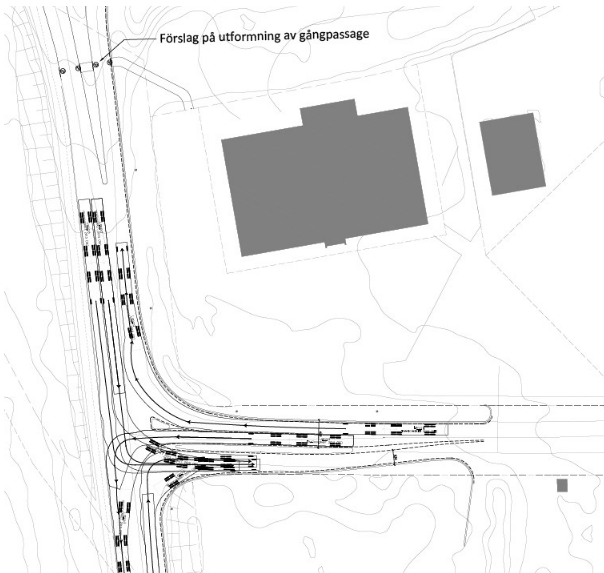
Figur 10. Exempel på utformning av korsning med 3 körfält.
