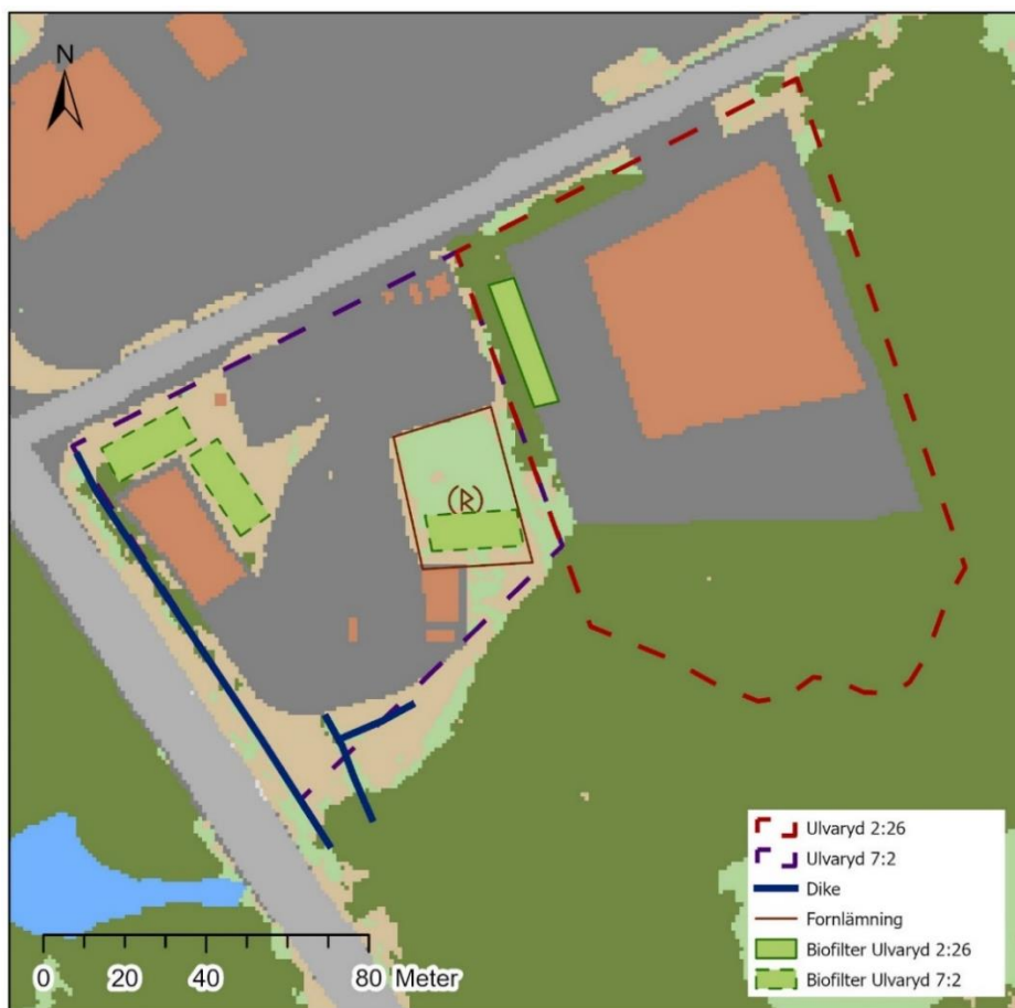
Figur 12. Förslag på möjliga placeringar av en biofilteranläggning på Ulvaryd 7:2. Biofilteranläggningarna har en area på 200 m 2 vardera. Enbart en av anläggningarna på Ulvaryd 7:2 krävs för att uppnå önskad reningseffekt.
